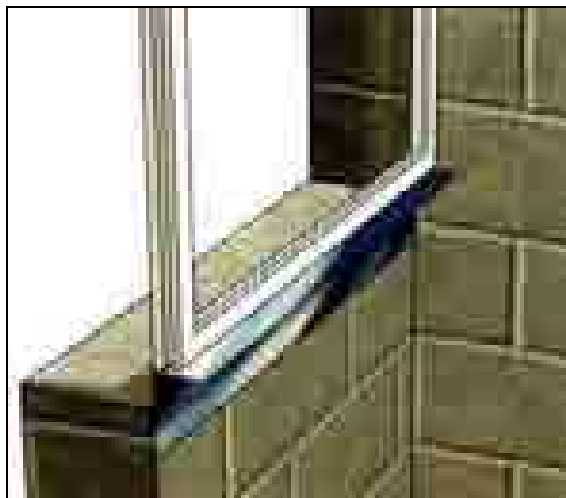
شکل ۴۳ طول ورق نبشی سراسری حداقل برابر با عرض خالص پنجره
