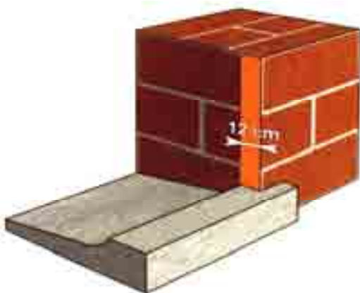
شکل ۳۹ مثال آماده‌سازی سطوح محل نصب پنجره با نکته‌گاه‌های بتنی توکار در یک دیوار آجر نمایان
