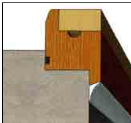
شکل ۹۸ بتانه‌کاری روکار از داخل درز بین دیوار و چارچوب قدیمی
