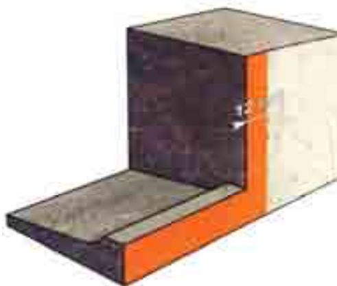
شکل ۳۶ مثال آماده‌سازی سطوح بتنی محل نصب پنجره با نکته‌گاه همباد
