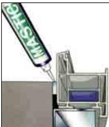
شکل ۶۶ درزبندی پروفیل تحتانی از طرف خارج
