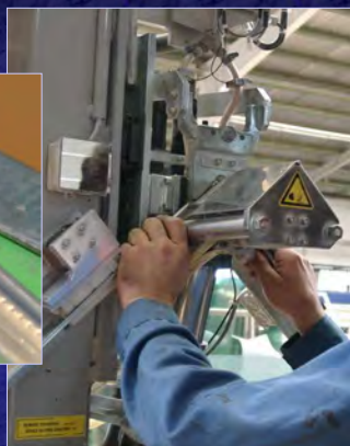
تزریق رطوبت گیر در داخل فاصله گذار (اسپیسر)
