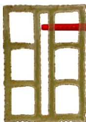
شکل ۱۲-۴۷- لزوم درگیری شدن رول‌پلاگ با حداقل دو بدنه بلوک سفالی
