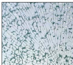
شکل ۱۲-۸۳- شکست در شیشه با عملیات حرارتی کامل
