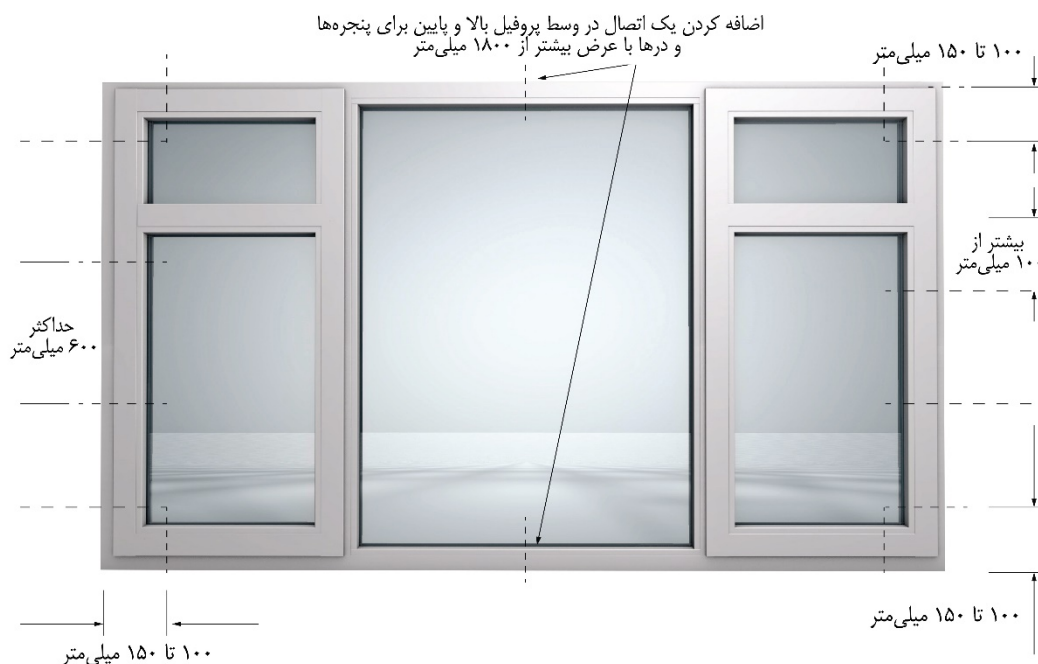
شکل ۱۲-۳۸- محل اتصالات پنجره‌ها و درهای آلومینیومی
