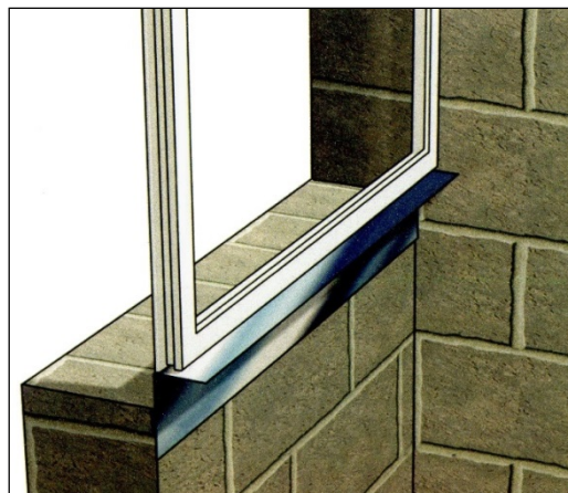
شکل ۱۲-۵۰- طول ورق نبشی سراسری حداقل برابر با عرض خالص پنجره
